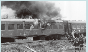
狩勝実験線での列車火災テスト
